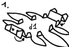
Il pezzo *d1* va preparato piegando in alto le linguette ai lati e ripiegando i corrimani anteriore e posteriore.
